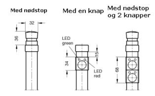
Type TO uden knapper Type T1 med 1 knap Type T2 med 2 knapper No. 1 uden nødstop No. 2 med nødstop
